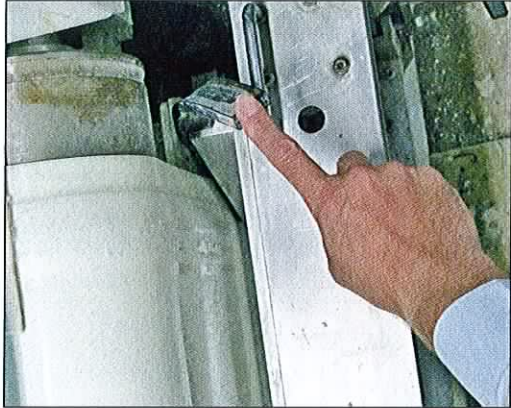
Для рекуперации лака Giardina используется два резиновых скребка, которые очень бережно удаляют остатки лака с транспортной ленты.
