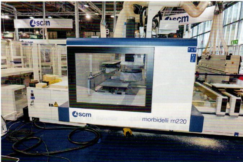
Neuzugang bei SCM: das CNC-Bearbeitungszentrum „Morbidelli M220“, eine Weiterentwicklung der „M200“-Baureihe. Die Maschine kann bei Bedarf auch an die neue IoT-Plattform „Maestro Connect“ angebunden werden
