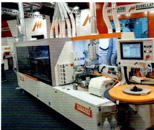
Rechts: Die Kantenanleimmaschine „Flexa 507 XE“ von Casadei-Busellato hat nun einen höheren Vorschub. Rechts daneben: Der „Multi Melt“-Tankschmelzer von Robatech ermöglicht einen schnellen Wechsel zwischen den Klebstoffen
