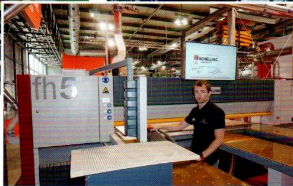
Roboter halten immer öfter Einzug in die Produktionshallen der Möbelindustrie, zu sehen etwa bei Biesse (links oben) und Homag (oben). Links: Die Plattenaufteilsäge „FH 5“ war Teil einer Losgröße-1-Anlage, die IMA Schelling in Mailand zeigte
