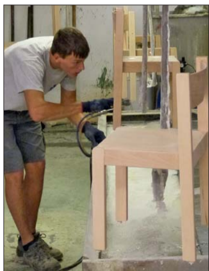
Bereits zusammengesetzte Möbel wie Stühle oder Tische werden von Hand lackiert.
