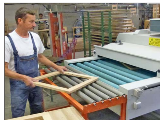
Am Bandende werden die Werkstücke mit einer UV-Einheit ausgehärtet und dann direkt abgestapelt.
