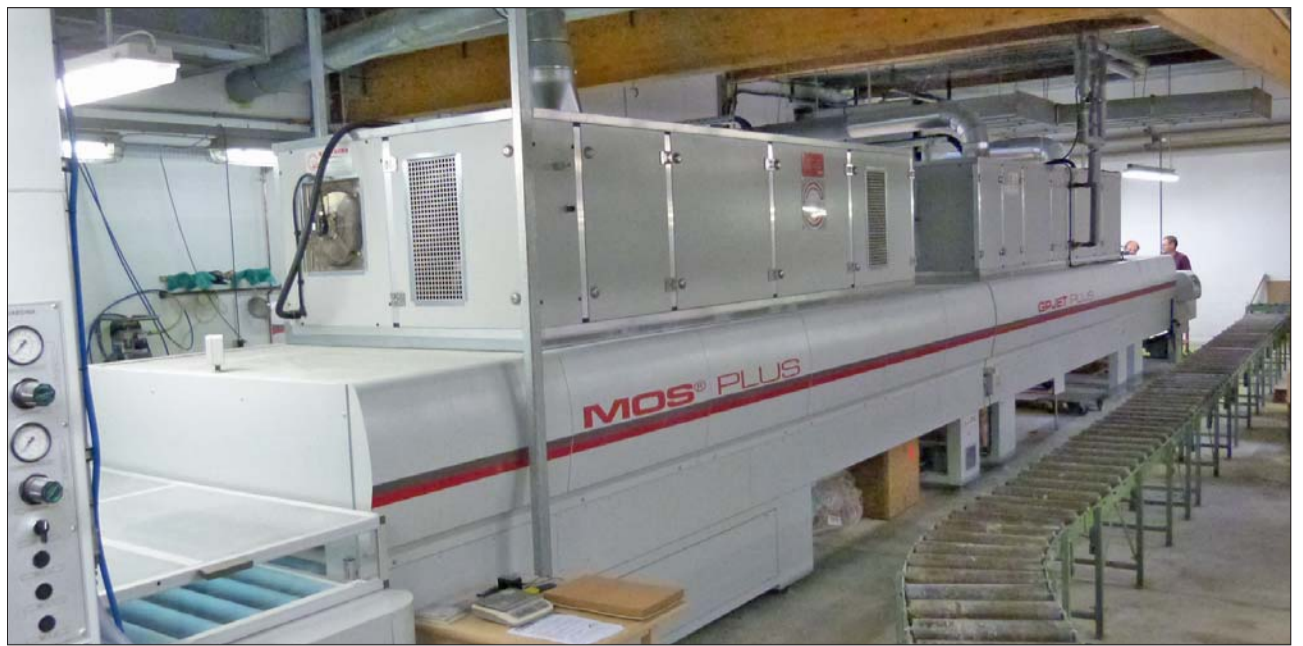
Die Lackierstraße von Giardina bei den König Möbelwerken ist gerade einmal 23 m lang.
