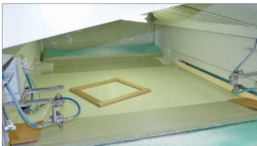
Herzstück der Straße ist die Lackiereinheit „Dualtech 412 Dry“, mit der bei König ausschließlich Klarlack gespritzt wird.
